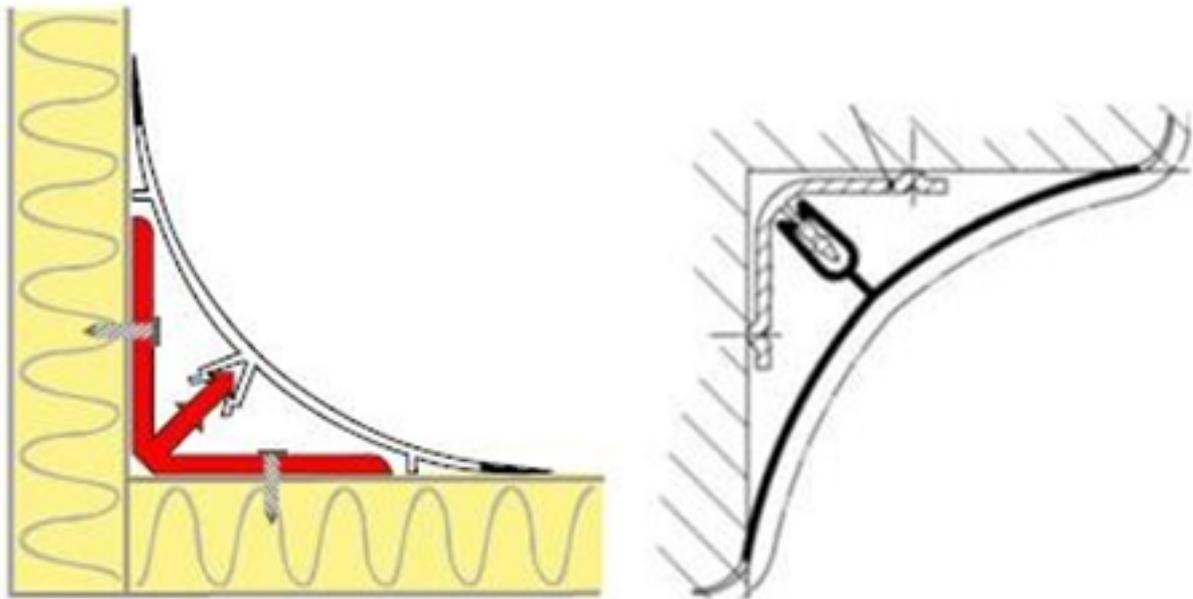
En las esquinas se hacen cortes a 45 grados y/o punta flecha, se aplica silicón para dar el acabado.
